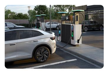
La configuration en stationnement parallèle est idéale pour que les électromobilistes puissent se garer à côté de la borne. Dans cette configuration, il y a une interface et un connecteur à l'avant et un à l'arrière.
